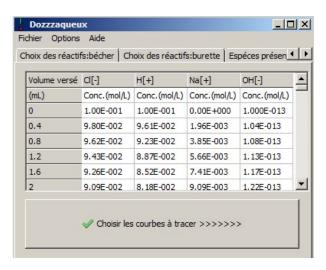
Exemple du titrage d'une solution d'acide chlorhydrique par de la soude.
